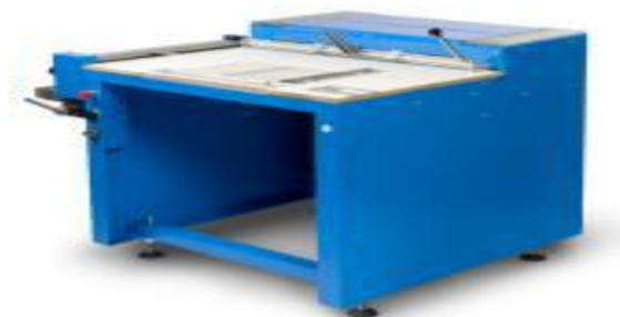
Fig. 4.36 Realizarea coperților semimanual
